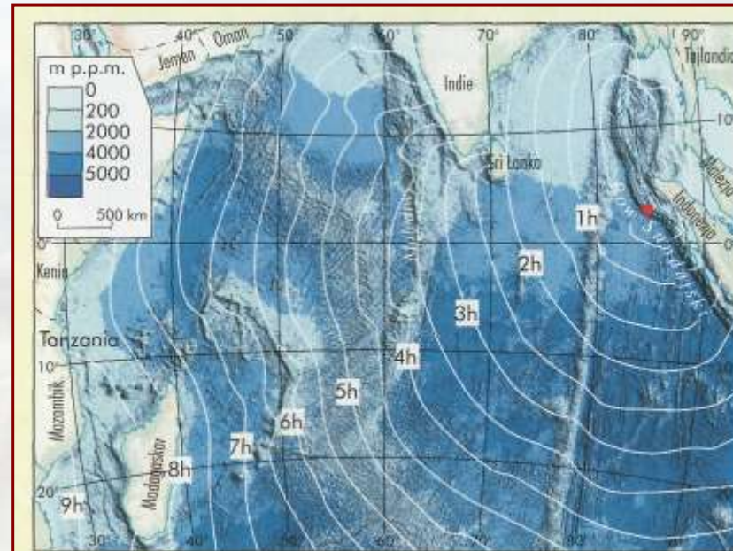
Schemat rozchodzenia się tsunami z dn. 26.12.2004 r. ● – epicentrum trzęsienia ziemi (hipocentrum na głębokości ok. 40 km), pod powierzchnią wody o sile 8,9° w skali Richtera
